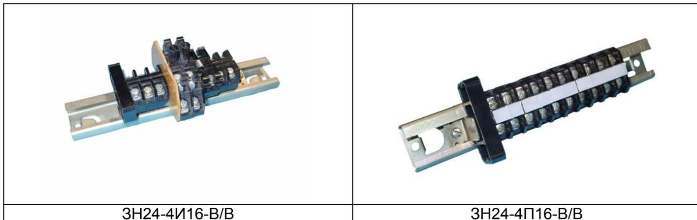
Зажимы предназначены для присоединения и ответвления медных и алюминиевых проводников в электрических цепях переменного тока напряжением от 6 до 660 В частоты 50 Гц и 60 Гц и постоянного тока напряжением от 6 до 440 В и применяются как комплектующие изделия в стационарных установках.
