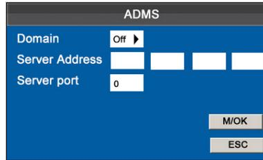
В начальном интерфейсе нажмите [M / OK] > Система > Ethernet > ADMS для входа в интерфейс настройки сервера ADMS.
