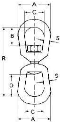
Такелажный вертлюг петля-петля позволяет двум присоединенным к нему такелажным элементам вращаться вокруг своей оси, что предотвращает скручивание цепей, тросов, канатов и снимает с них лишние нагрузки. Вертлюг петля-петля не имеет разборных частей, поэтому для соединения элементов необходим карабин или соединительное звено.
