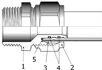
Корпус фитинга(1), гайки(2) и обжимного кольца(3) выполненных из латуни CW617N (EN 12165), уплотнительные кольца (4) – EPDM (этилен-пропиленовый каучук), диэлектрическое кольцо (5) – тефлон.
