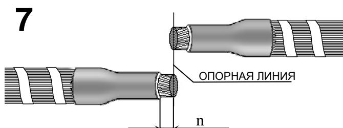
На конец кабеля надвинуть упорную шайбу, продвинув её до среза оболочки и с помощью специального инструмента (роликового ножа) снять электропроводящий экран с жилы кабеля, оставив участок длиной 40 мм у среза оболочки кабеля.
