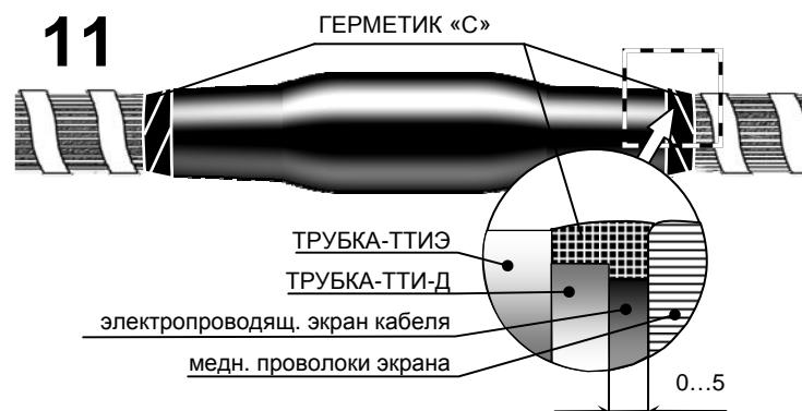
Надвинуть на гильзу изолирующую трубку (ТТИ-Д) так, чтобы она располагалась симметрично на соединительной гильзе. Задиры герметика при надвигании трубы не допускаются. Усадить трубку, начиная с середины, далее в обе стороны. Затем на неё надвинуть изолирующую экранированную трубку (ТТИЭ), установить её так, чтобы она располагалась между проволочными экранами кабелей. Усадить трубку, начиная с середины, далее в обе стороны.
