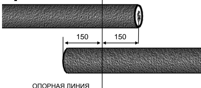
Распрямить концы соединяемых кабелей на длине не менее 1500 мм . Уложить внахлест в соответствии с указанными в таблице размерами. Отметить опорную линию.
