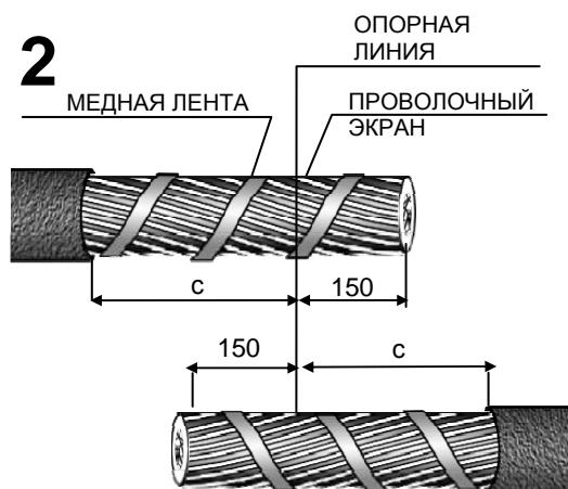
На расстоянии С от конца кабеля выполнить кольцевой надрез по оболочке кабеля с помощью льняной нити. Удалить наружную оболочку с конца кабелей по размерам, указанным на рисунке. Для облегчения снятия оболочки подогреть её пламенем горелки до температуры 50...70 °С.
