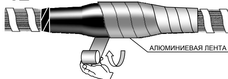
Поверх усаженной трубы ТТИЭ произвести подмотку алюминиевой лентой с перекрытием на 20 мм до упора в медные проволоки экранов кабелей, плотно обжав по всей длине муфты.
