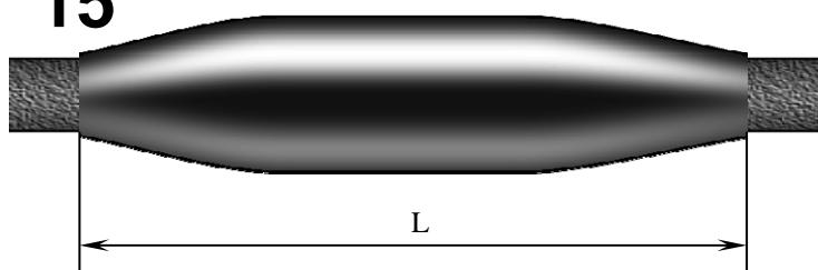
Обмотать место соединения экранов лентой ПВХ. Обезжирить оболочку кабеля и наложить ленту герметика «С» № 2, на правой и левой стороне муфты у среза оболочки на длине 45 мм.
