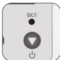
Индикация состояния реле
