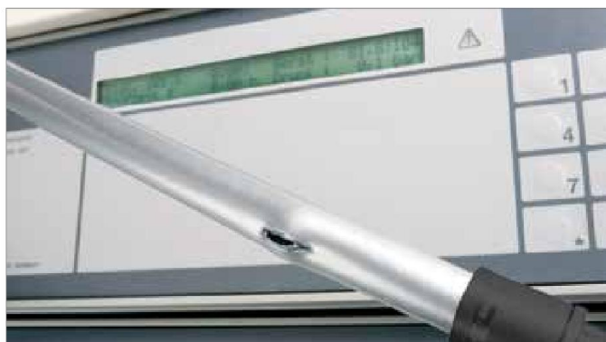
Рис. 3-1 Результаты испытания прочности на разрыв давлением. Испытуемый продукт – универсальная труба RAUTITAN flex
