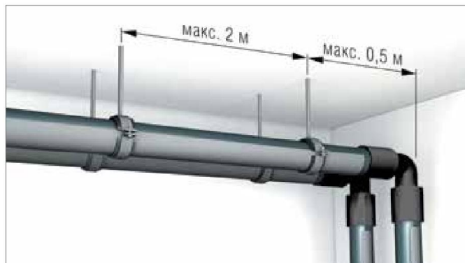
Рис. 13-3 Максимальное расстояние между хомутами
