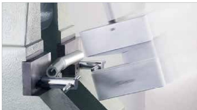
Рис. 3-2 Универсальная труба RAUTITAN flex в установке по испытанию ударной вязкости
