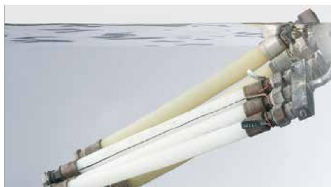
Рис. 3-4 Трубы в момент длительного испытания (под давлением в водном резервуаре)
