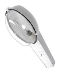
Мощность, Вт: 125 Тип лампы: ДРЛ Патрон: E27 IP: IP54 Тип КСС: III Масса, кг: 4
