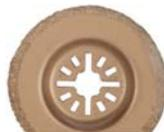
Ступенчатый, карбидный. Диаметр лезвия 64 мм. Для резки бетона и кафельной плитки. Материал: основание из легированной инструментальной стали, режущая кромка содержит порошок из карбида вольфрама. Упаковка: блистер.
