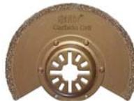
Ступенчатый, карбидный. Диаметр лезвия 85 мм. Для резки бетона и кафельной плитки. Материал: основание из легированной инструментальной стали, режущая кромка содержит порошок из карбида вольфрама. Упаковка: блистер.
