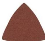
Треугольные. Набор из 5-ти штук с разной зернистостью (P60, P80, P120, P180, P240). На тканевой основе. С липучкой. Для установки на подошву для шлифовальных листов. Для обработки различных материалов. Для сухого шлифования. Материал: тканевая х/б основа, алюминий-оксидный абразивный слой. Упаковка: блистер.
