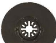
С 8% добавкой кобальта. Дисквое. Ступенчатое. Фрезерованное. Диаметр лезвия 87 мм. Шаг зубьев 1,4 мм. Для резки стали, а также цветных металлов, твердых пород древесины и пластика. Материал: лезвие из быстрорежущей (HSS) стали P6M5K8, основание из инструментальной стали. Упаковка: блистер.
