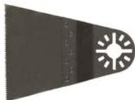
3D заточка. Ступенчатое. Шлифованное. Ширина лезвия 68 мм. Шаг зубьев 1,8 мм. Для резки твердой и мягкой древесины, столярных плит, ДВП, ДСП и пластика. Материал: лезвие из хром-ванадиевой стали, основание из инструментальной стали. Упаковка: блистер.
