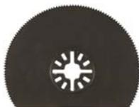
С 8% добавкой кобальта. Дисквое. Прямое. Фрезерованное. Диаметр лезвия 80 мм. Шаг зубьев 1,4 мм. Для резки стали, а также цветных металлов, твердых пород древесины и пластика. Материал: лезвие из быстрорежущей (HSS) стали P6M5K8. Упаковка: блистер.
