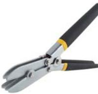
Применяются для гофрирования заготовок из листового металла (в том числе из цветных металлов) толщиной до 0,9 мм. Основная область применения - гофрирование элементов металлической водосточной системы для их последующей стыковки между собой. Глубина сгиба - 35 мм. Материал: инструментальная сталь, ПВХ покрытие ручек. Упаковка: блистер. | 10/20 |
