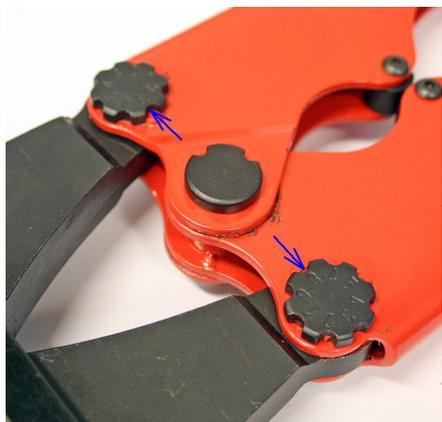
4.2. В случае, когда зазор между полуобоймами при сомкнутых рукоятках более 2мм, следует переставить эксцентрики на меньшее значение по шкале. Для этого следует развести рукоятки инструмента примерно на 30°, и открутить самоконтращиеся гайки эксцентриков. Не рекомендуется устанавливать разные значения на эксцентриках. После установки эксцентрика в требуемое положение, гайки следует установить на место и затянуть.
