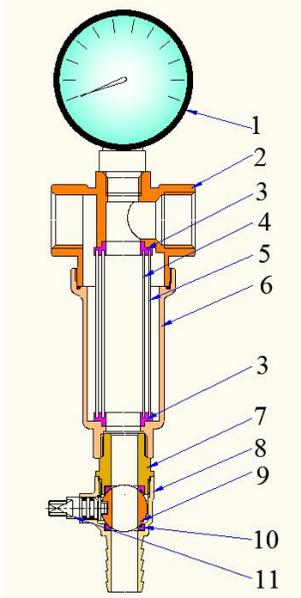
Фильтр состоит из корпуса 2 и колбы 6, выполненных из горячештампованной латуни CW617N с гальванопокрытием из никеля. Между собой корпус и колба соединены на резьбе с кольцевой прокладкой из EPDM.
