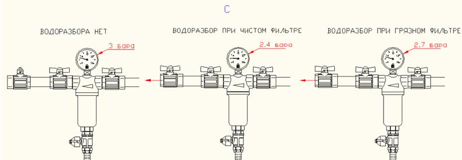
7.3. Промывка фильтра может производиться четырьмя различными способами:
