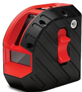
Компактный лазерный уровень проецирующий одну горизонтальную и одну вертикальную линии. Отличается большой разверткой вертикальной линии и встроенными магнитами для крепления на металле. Может работать от блок питания и на больших дистанциях с приемником.
