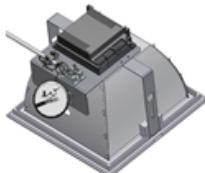
3.2.1. Сетевой провод проложить через кабельный зажим и подключить к клеммной колодке в соответствии с указанной полярностью (клеммная колодка находится на корпусе светильника).
