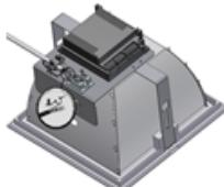
3.2.1. Мережевий провід провести через кабельний затиск і підключити до клемної колодки відповідно до зазначененої полярності (клемна колодка знаходиться на корпусі світильника).
