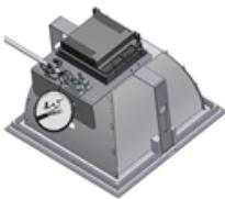
3.2.1. Желілік сымды кабельдік қысқыш арқылы өткізіп және көрсетілген поляризацияға сәйкес клеммалы қалыпта косу керек (клеммалы қалып шамшырақ корпусында болады).
