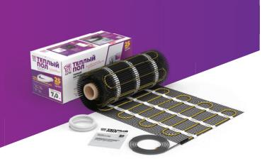
Теплый пол «OneKeyElectro» на основе нагревательных матов применяется для комфортного обогрева помещения. Маты могут устанавливаться под любое напольное покрытие: ламинат, линолеум, керамическая плитка, керамогранит. Нагревательный кабель надежно зафиксирован на сетке, которая позволяет быстро разложить мат. Мат устанавливается в слой плиточного клея 5-8 мм.
