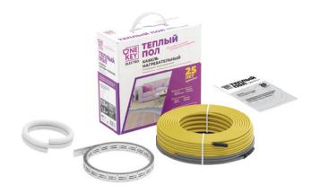
Теплый пол «OneKeyElectro» на основе нагревательного кабеля может применяться как для основного, так и для комфортного обогрева помещения, устанавливается в в слой цементно-песчаной стяжки 3-5 см или в слой плиточного клея 5-8 мм.
