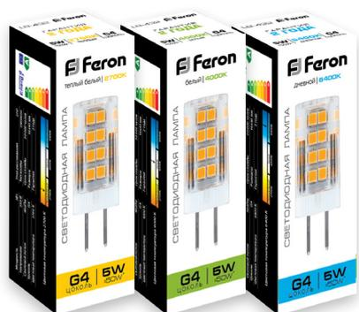
Светодиодные лампы LB-432 и LB-433 являются заменой галогенных капсульных ламп и подойдут для встраиваемых светильников и люстр с патроном G4. Лампы обладают прекрасной светоотдачей и заменяют стандартные лампы мощностью 50W и 70W соответственно.
