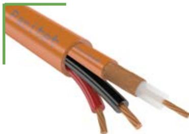
**КВК-Пнг(А)-HF** – кабель с одним радиочастотным элементом и жилами питания и управления, выполненными из медной мягкой проволоки в изоляции из термопластичной композиции, не содержащей галогенов, в общей оболочке из термопластичной композиции, не содержащей галогенов.
