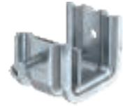
Этот вид балочного зажима надвигается на опору и фиксируется с помощью прижимной пластины и винта (M8) на опоре или полосовой стали. Болт имеет ключевую ширину 10 мм. В корпусе скобы имеется также 2 резьбы M6, например, для крепления стержня с резьбой.
