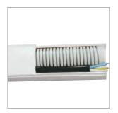
Двойной замок обеспечивает плотное соединение крышки кабель-канала с основанием, что позволяет укладывать внутри кабель-канала жесткие предметы (например, гофротрубу), а также производить монтаж кабель-канала на потолке.
