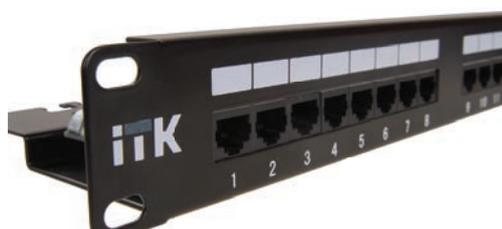
Коммутационные панели или патч-панели являются важнейшей частью любой СКС и ИТ-инфраструктуры здания и сооружения с большим количеством информационных розеток и терминальных портов конечных пользователей, которые необходимо коммутировать на порты активного сетевого оборудования, размещенного в серверных и распределительных узлах.
