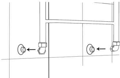
18. Протягиваем все соединения специальным инструментом (разводным ключом).
