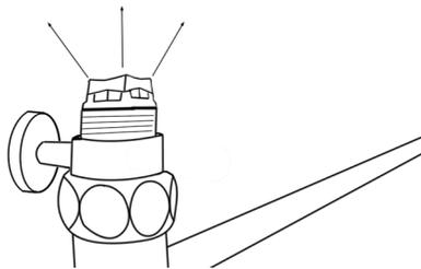
23. Закрываем клапан крана Маевского
