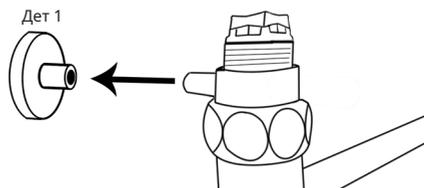
17. Накручиваем угловое соединение на эксцентрики
