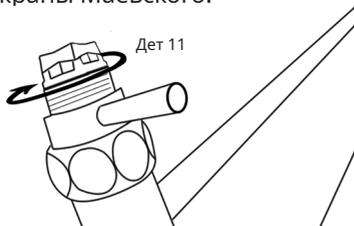
7. На эксцентрики подматываем сантехническую нить (в комплект не входит) и вворачиваем в подводку центральной системы отопления или водоснабжения с необходимым количеством витков
