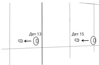
15. В гайки угловое соединение вкладываем прокладки.
