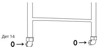
16. Берем полотенцесушитель вставляем шпильки в держатели и затягиваем шестигранным ключом стопорные винты в держателях
