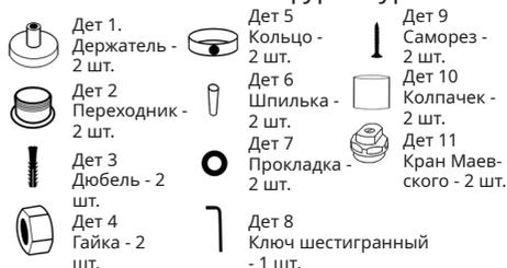
4. Надеваем кольцо на переходник, вкручиваем в кольцо шпильку, затягиваем отверткой. Повторяем ту же операцию с противоположной стороной.
