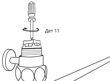
24. Накручиваем оставшиеся верхние колпачки из комплекта К1. Изделие готово к эксплуатации
