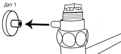
7. Ослабляем винт на одном кране Маевского с противоположной стороны относительно тэна. При помощи плоской отвертки.
