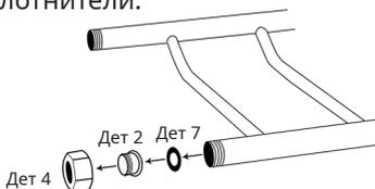
5. Закручиваем краны Маевского в свои гнезда. Проверяем, закрыты ли сами краны Маевского.
