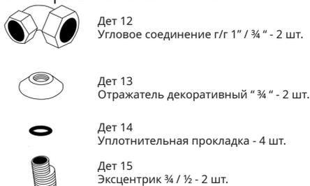
8. Вкладываем прокладки в угловое соединение и накручиваем на полотенцесушитель.
