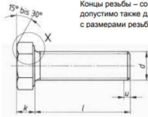
Концы резьбы – согласно DIN 78-K, допустимо также для болтов без фаски с размерами резьбы  $\leq M4$
