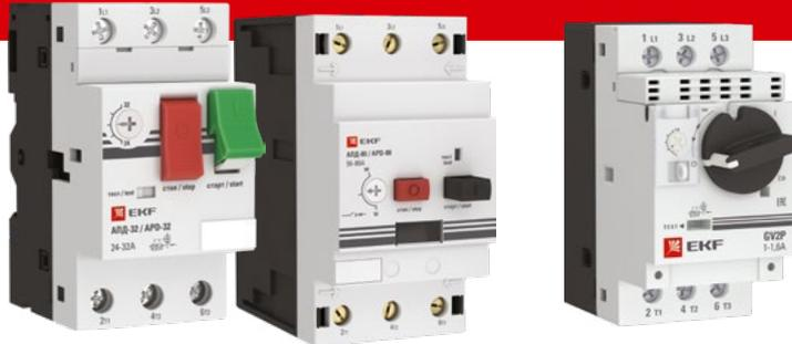
Автоматические выключатели пуска двигателя серии GV2P ЕКФ, АД-32 ЕКФ и АД-80 ЕКФ с термомангнитным расцепителем специально предназначены для коммутаций цепей переменного тока напряжением до 690 В частотой 50/60 Гц, а также для управления и защиты трехфазных асинхронных двигателей от перегрузки, обрыва фазы, короткого замыкания.
