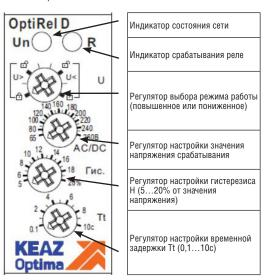
3.2 Панель управления реле контроля и повышенного, и пониженного напряжения
