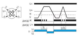
3.9.2 Функция контроля повышенного напряжения без возврата состояния. Используется для отключения оборудования при повышенном напряжении питания.
