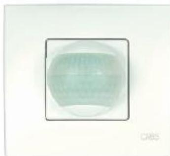
Датчик движения ORBIMAT для установки в универсальный бокс с углом сканирования 195° и областью обнаружения 8 метров. Ручное управление: постоянно выключен, автоматический режим, постоянно включен. Обнаруживает движущиеся объекты (излучающие в ИК спектре) в зоне действия, не излучает радиоволны. Рекомендован для использования в коридорах, прихожих и ванных комнатах.
