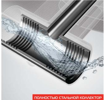
Применение полностью стального закладного элемента, выполненного из углеродистой стали марки 20, которая отличается повышенной коррозионной стойкостью и эксплуатационной надежностью. В биметаллических радиаторах Royal Thermo полностью исключен контакт теплоносителя с алюминием, отсутствуют заужения в местах сварки, соответственно, обеспечивается 100% проходимость теплоносителя.
