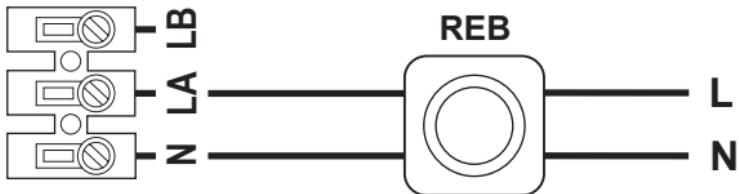
Funcionamiento a través de un regulador de velocidad variable Tipo REB
