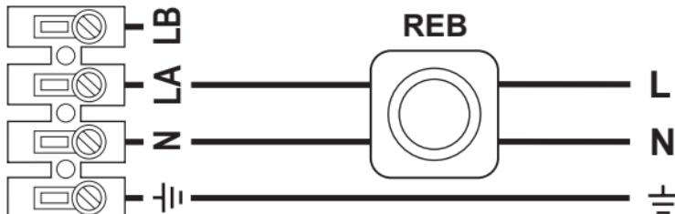
Funcionamiento a través de un regulador de velocidad variable Tipo REB
