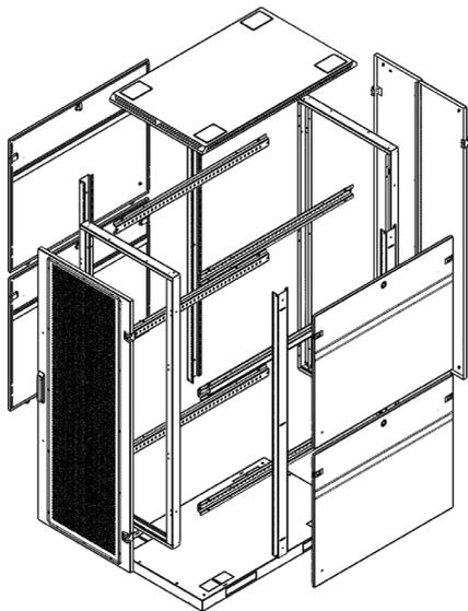
Рис. 1 Разнесенный сборочный чертеж
