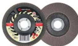
Предназначен для УШМ, посадка 22,23 мм. Наполняемость круга 72 лепестка (28x17мм) с углом наклона 10 градусов, что позволяет увеличить площадь контакта с поверхностью. Используется для обработки различных поверхностей: металл, дерево, пластик. Материал: инструментальная сталь, тканевая основа, абразивный материал.
