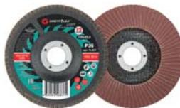
Предназначен для УШМ, посадка 22,23 мм. Наполняемость круга 72 лепестка (25x15мм) с углом наклона 10 градусов, что позволяет увеличить площадь контакта с поверхностью. Используется для обработки различных поверхностей: металл, дерево, пластик. Материал: инструментальная сталь, тканевая основа, абразивный материал.
