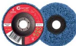
Зачистной полимерный (нейлоновый) круг предназначен для УШМ, посадка 22,23 мм. Используется для обработки поверхности от: ржавчины, коррозии, старой краски, клея, эпоксидных покрытий и других загрязнений. Не снимает металл и не изменяет форму поверхности. Круги синего цвета имеют более грубую зернистость и агрессивную структуру. Материал: инструментальная сталь, нейлоновые волокна с абразивным слоем из карбида кремния.
