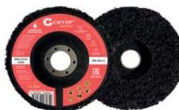
Зачистной полимерный(нейлоновый) круг предназначен для УШМ. Посадка 22,2 мм. Обеспечивает мягкую очистку поверхности от: Ржавчины, коррозии, старой краски, клея, эпоксидных покрытий и других загрязнений. Не снимает металл и не изменяет форму поверхности. Обрабатываемые материалы: сталь и нержавеющая сталь(INOX), дерево, пластмасса, композитные материалы. Материал: инструментальная сталь, нейлоновые волокна с абразивным слоем из карбида кремния.
