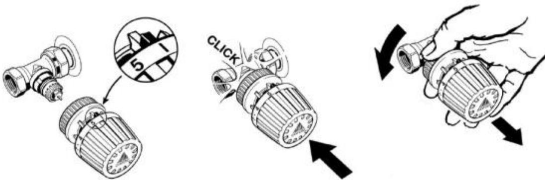
Элементы термостатические типа RTR настраиваются на требуемую комнатную температуру поворотом рукоятки с нанесенной на нее круговой шкалой. Температурная шкала показывает взаимосвязь между обозначениями на ней и комнатной температурой.
